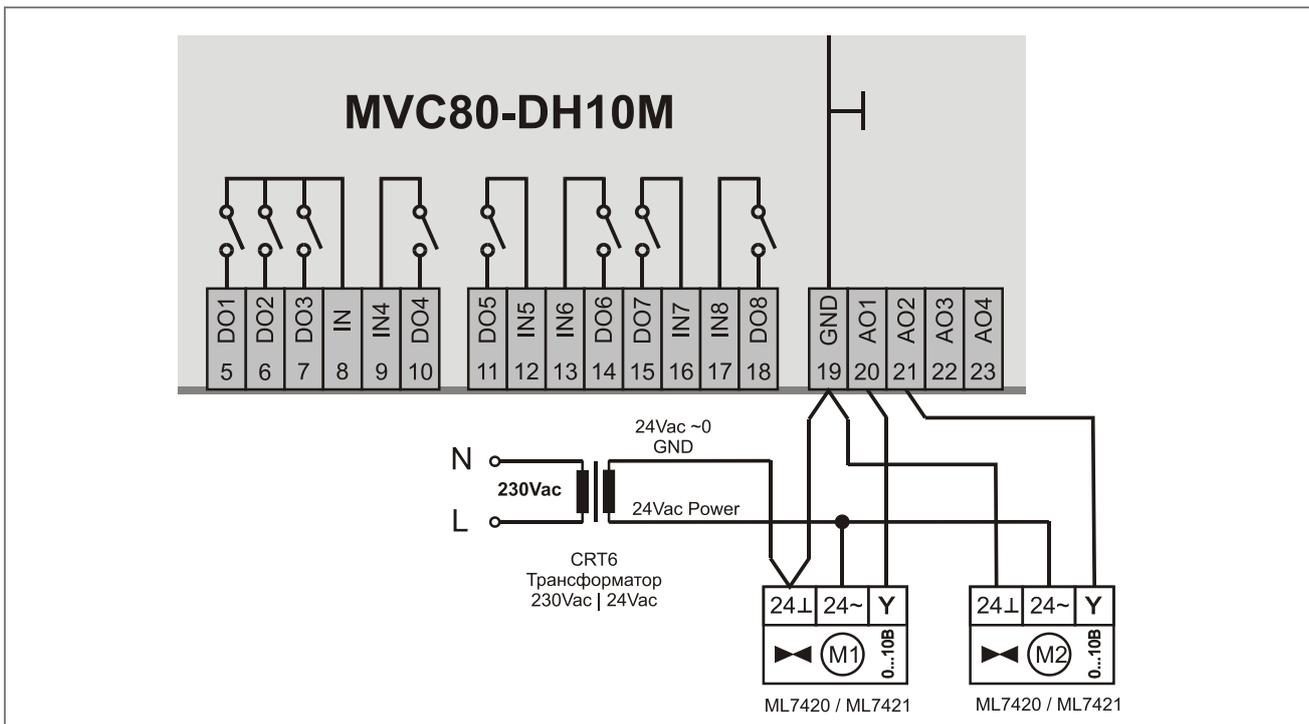
**Эл. подключения приводов ML7420 / ML7421 с аналоговым управляющим сигналом к контроллеру MVC80-DH10M**
