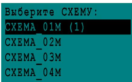
Если вы производили сброс контролера, то последняя загруженная схема, которая была активна в контроллере до сброса, отмечена (1).
