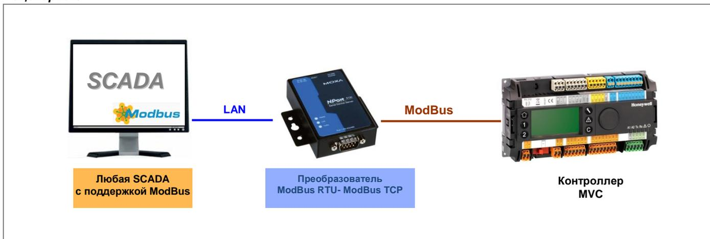
Рис. 1. Конфигурация системы с контроллером MVC (Modbus)
