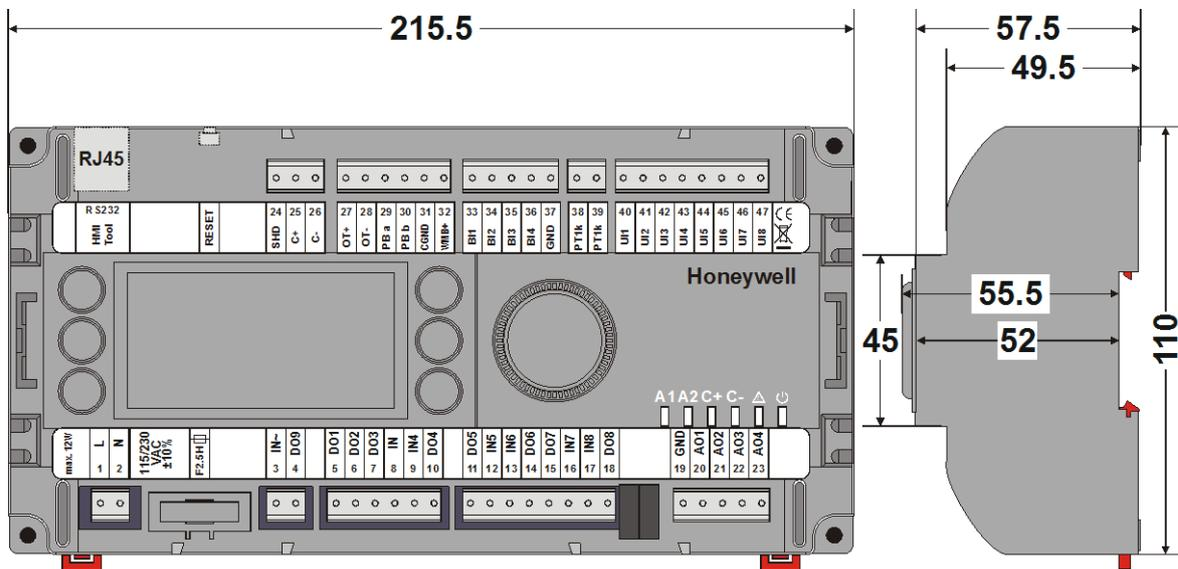
Рис. 4. Размеры контроллера MVC без дополнительных панелей (в мм.)
